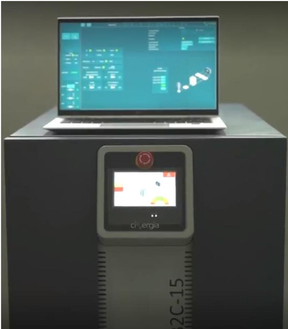
Ilustración 3 - Vista frontal del ciclador con su software de control
