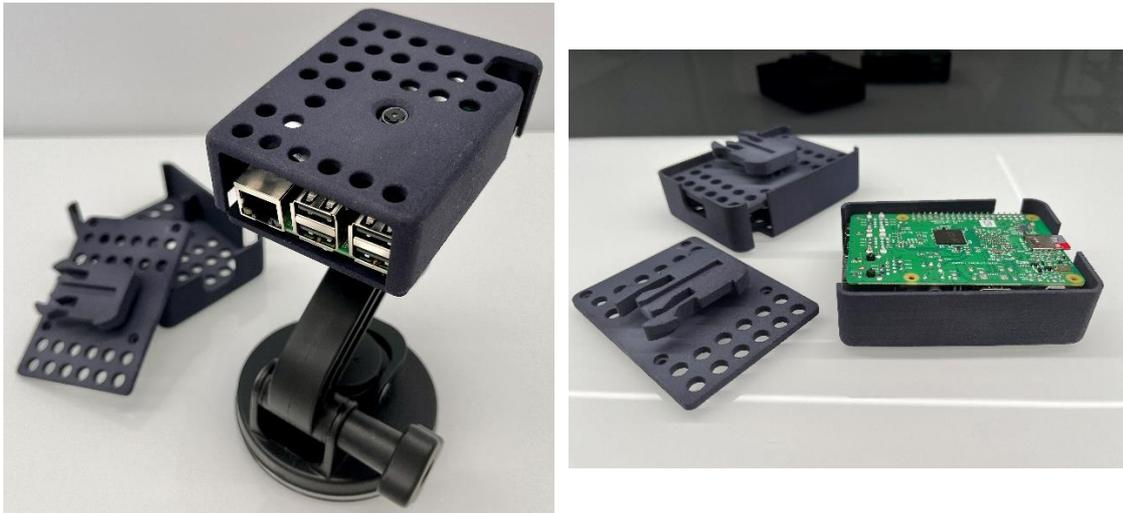
Figura 13: Cámara y placa de control montada con la caja y el soporte de ventosa.
