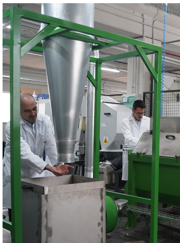
Figura 1. Equipo de descontaminación de vapor de agua a escala piloto.
