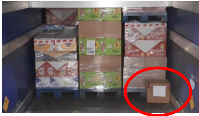
Figura 4. Montaje del dispositivo de registro de vibraciones; caja de cartón ondulado.
